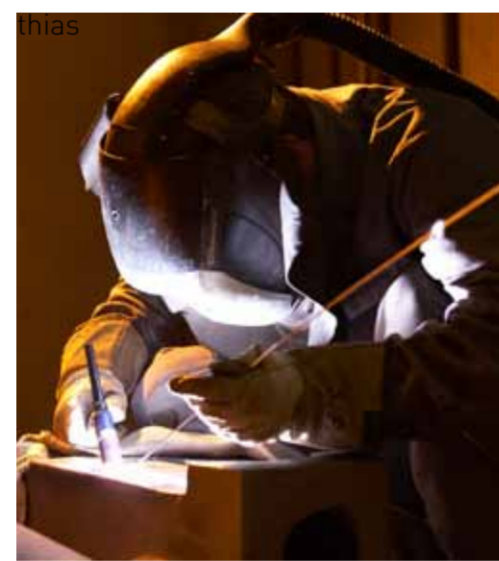
Ein Mitarbeiter im Vollschatzanzug mit Sauerstoffzufuhr und integriertem Visier beim MIG-Schweißen.
