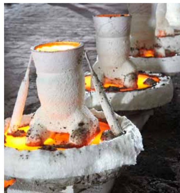
Gerade gegossene Keramikschalen in der Abkühlphase.
