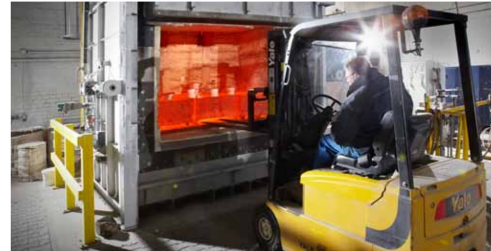
Die keramischen Formschalen werden nach dem Brennen, bei dem das 3-D-gedruckte Modell vollständig vergast, aus dem Ofen genommen und sofort vergossen.
